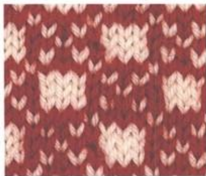
样品2 用精纺线、4号针（3.5mm）织成。织物密度为每5cm有12针或者12圈。这是毛衣的标准密度；针脚均匀，两针间没有空隙。织出的东西紧实而有弹性。
