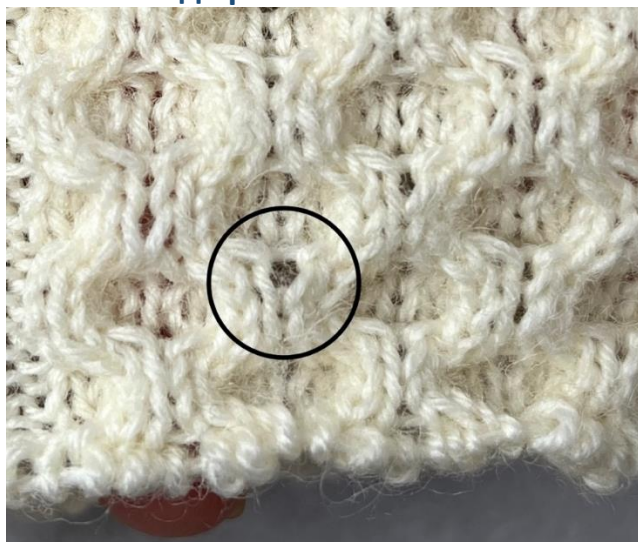
Рисунок 4. Внешний вид узора «Соты» с дефектом.
