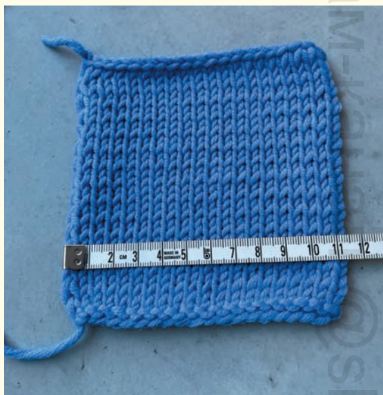
Измерение количества петель образца
