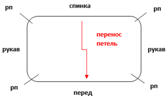
Рис. 2. Изображение переноса петель
